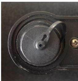
4. **Cargador de Batería:** La recarga se realiza a través de una fuente de 12VDC
