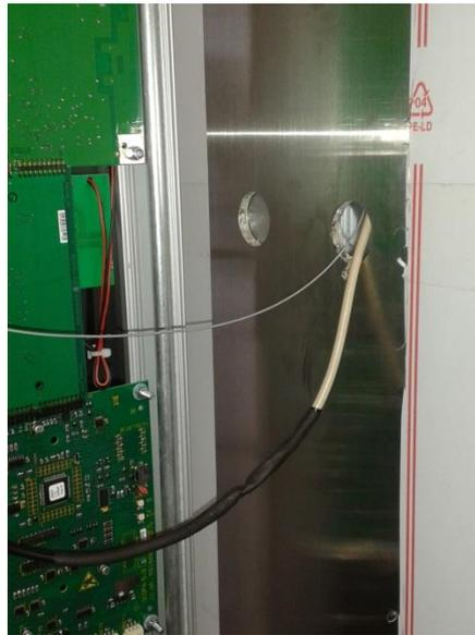
**Figura 9: Ducto por el cual Introducir el Cable del Lector**
