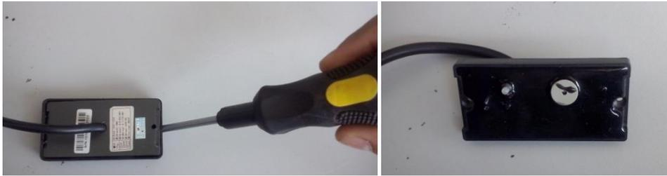
**Figura 7: Retirar la Carcasa del Lector**
