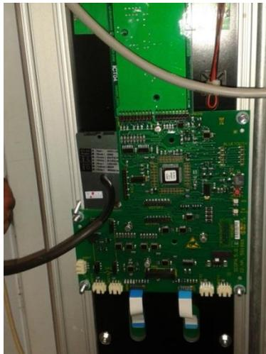
**Figura 8: Lector Colocado Dentro de la Botonera**
